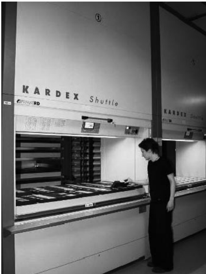
Slika 8. Arhivski silos za digitalne kasete tipa shuttle
